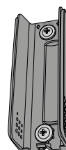
Abb. 4. Rückteil. Schraubmontage an der Wand. Schraube max. Ø4,5 mm, min. Länge 20 mm, Schrauben werden nicht mitgeliefert.
