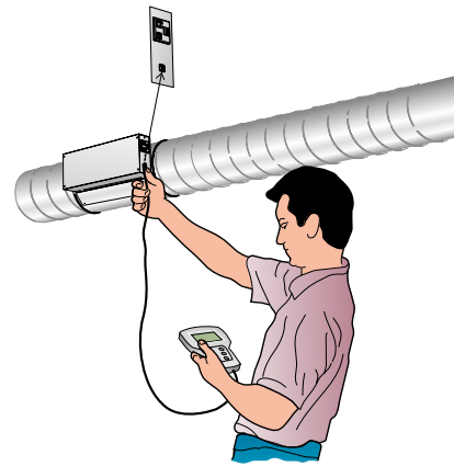
Kuva 5. TUNE Adapt –laitteen kytkeminen asetusarvojen tarkastusta ja muuttamista varten. Kytketään suoraan pellin sivuun tai jatko kaapelin kytkentärasiaan. Jos DETECT SME on asennettu, TUNE Adapt kytketään siihen. Kun TUNE Adapt kytketään, yhteys rakennusautomaatiojärjestelmään katkeaa.
