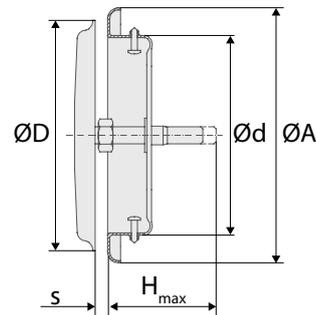
Abb. 5. TRAC, Abmessungen.
