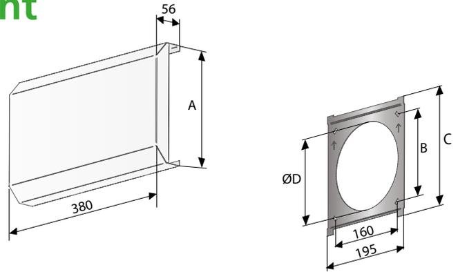
Abb. 3. SOTTO, Abmessungen.
