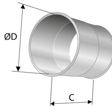
Abb. 4. VGC, Abmessungen.
