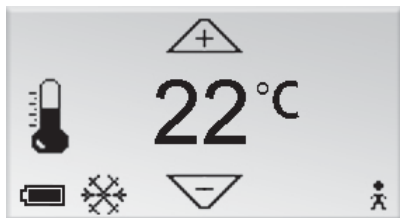
Kuva 4. Lämpötilan asetuskäytön näkymä.
