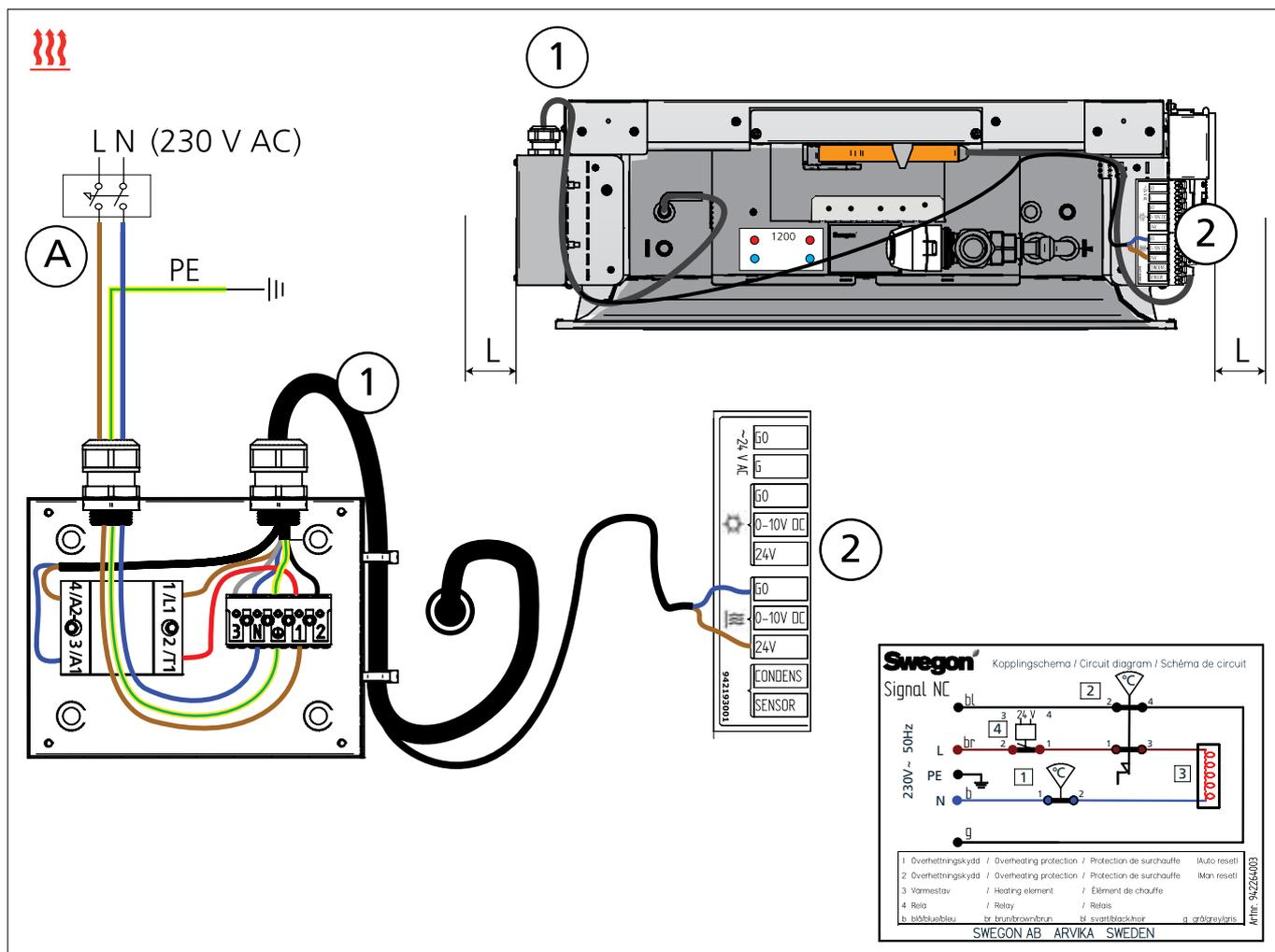
A: Allpolig brytare, brytavstånd >3mm; A: Double-pole switch, contact separation >3mm
