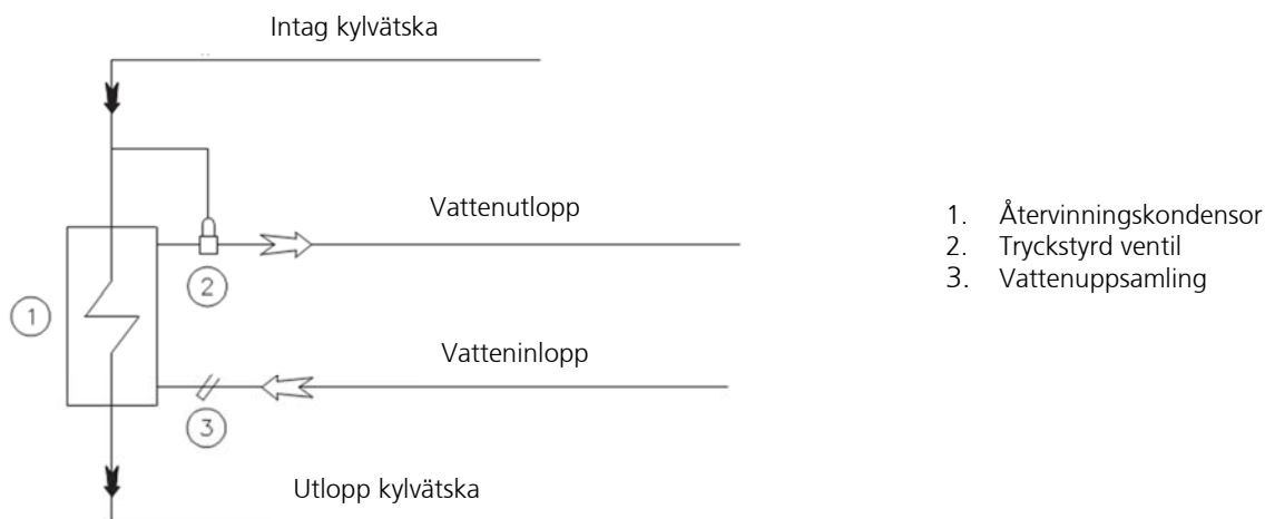
Fig. 10: installationsschema för tryckstyrd ventil
