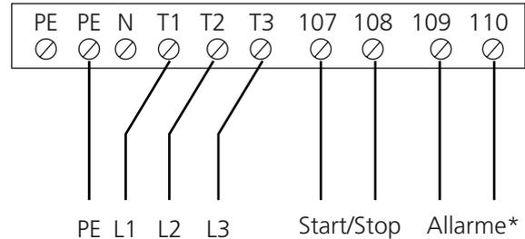
\* Selezionare l'allarme con contatto normalmente aperto/normalmente chiuso e pompa con controllo a velocità fissa nel micro terminale manuale dell'unità GOLD.
