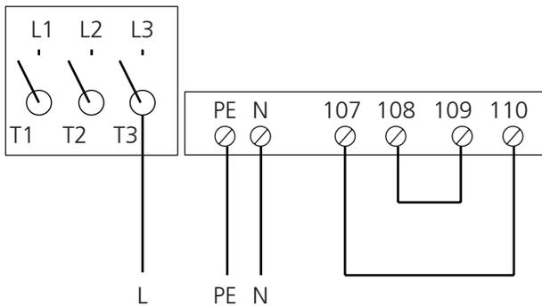
Montare un ponticello dal Terminale 107 al Terminale 110. Montare un ponticello dal Terminale 108 al Terminale 109. Selezionare il feedback del contattore e la pompa con controllo a velocità fissa corretti nel micro terminale manuale dell'unità GOLD
