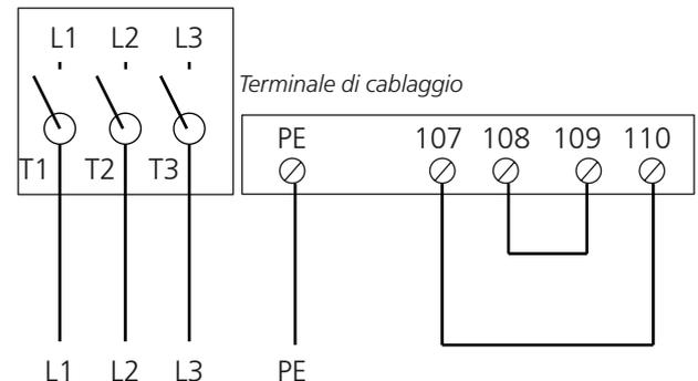
Montare un ponticello dal Terminale 107 al Terminale 110. Montare un ponticello dal Terminale 108 al Terminale 109. Selezionare il feedback di contatto e la pompa con controllo a velocità fissa corretti nel micro terminale manuale dell'unità GOLD
