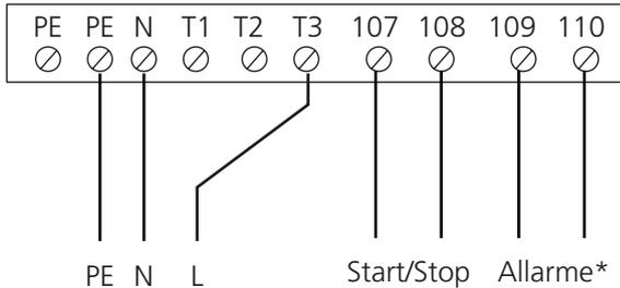
\* Selezionare l'allarme con contatto normalmente aperto/normalmente chiuso e pompa con controllo a velocità fissa nel micro terminale manuale dell'unità GOLD.
