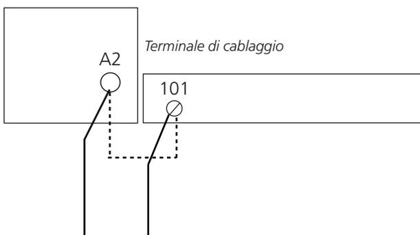
Collegare i contatti termostatici al Contattore A2 e al Terminale 101. Scollegare il ponticello tra il Contattore A2 e il Terminale 101.
